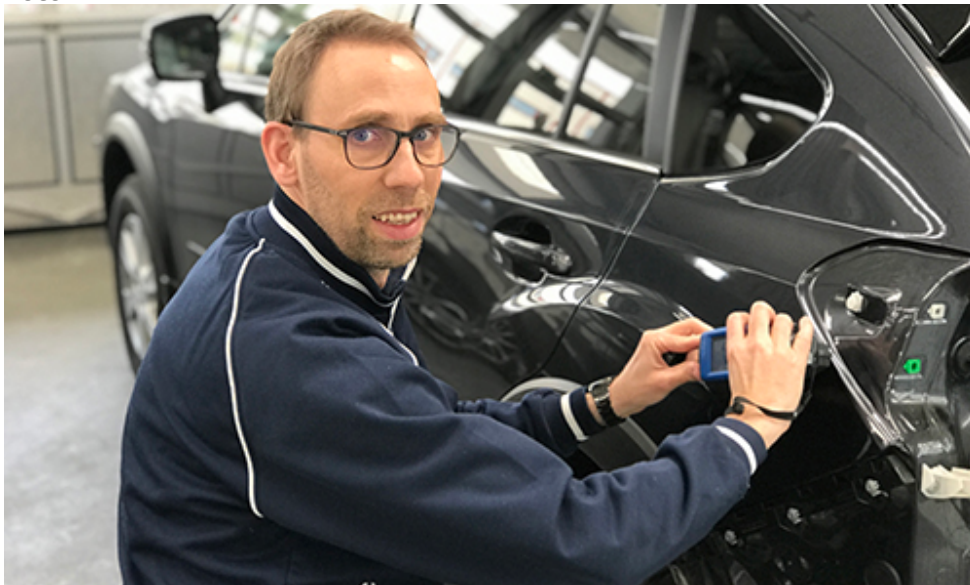
Bildunterschrift 2: Urs Wesemann misst den Farbton nur noch digital mit dem Genius iQ2 von Standox.
